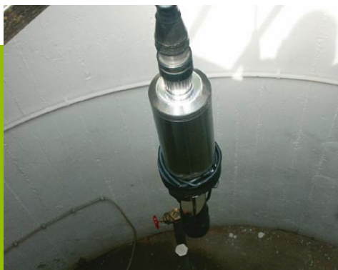
Optische Untersuchung eines Brunnen mit Hilfe der Unterwasserkamera.
