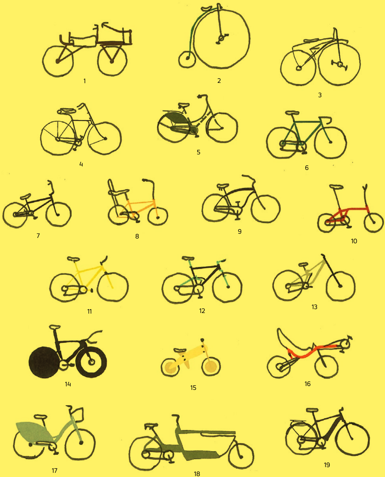
1 Laufmaschine, 1817 (Karl von Drais) 2 Hochrad, 1870 (James Starley) 3 Tretkurbelrad, 1870 (Eugène Meyer) 4 Safety Bicycle, 1885 (John Kemp Starley) 5 Hollandrad, 1896 6 Rennrad, heute / erstmals 1903 7 BMX Rad, 1960 8 Bonanzarad, 1963 9 Beach Cruiser Rad, 1980 / erstmals 1933 10 Faltrad, heute / erstmals 1896 11 Mountainbike, 1973 12 vollgefedertes Mountainbike, 1985 13 Downhill-Rad, 2005 / erstmals Mitte 1990er 14 Triathlon-Rad, heute / erstmals 1970 15 Kinderlauftrad, 1997 16 Liegerad, heute / erstmals 1896 17 KVV Nextbike, 2004 18 Lastenrad, heute / erstmals 1920 19 E-Bike, heute / erstmals 1895
